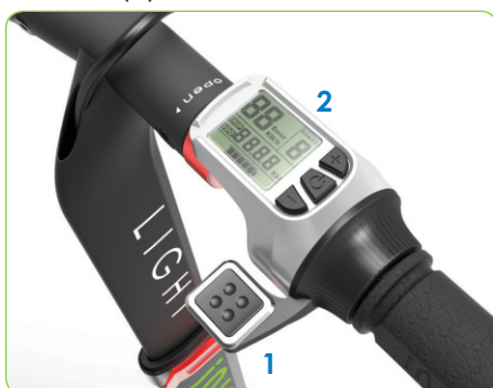
Акселератор (1) и мултифункционален дисплей (2)
