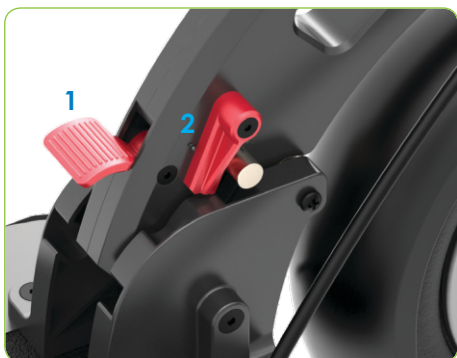
Сгъващ механизъм със самозаклучващ лост (1) и осигурителен палец (2)
